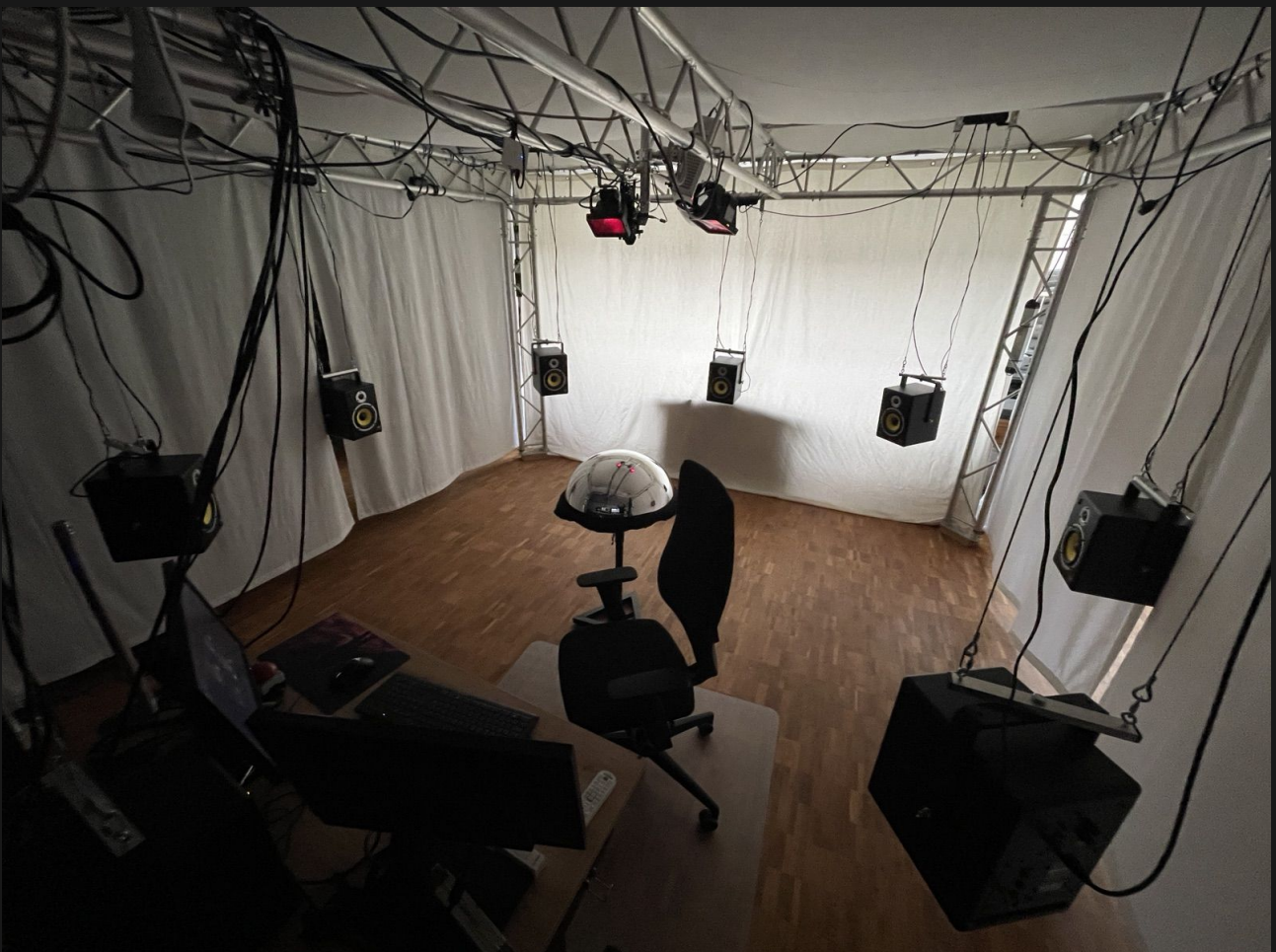
4x4m Testaufbau mit 8 Kanälen Raumklang
